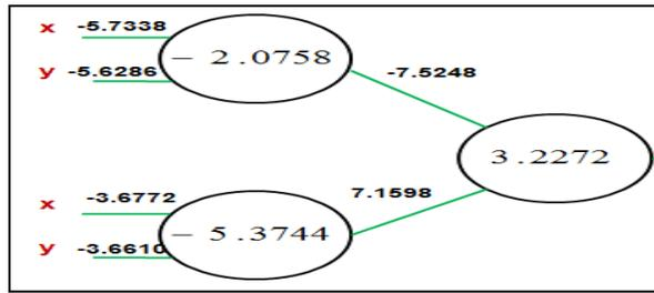
Figura 3. Solución de la función booleana *xor* de dos variables.
